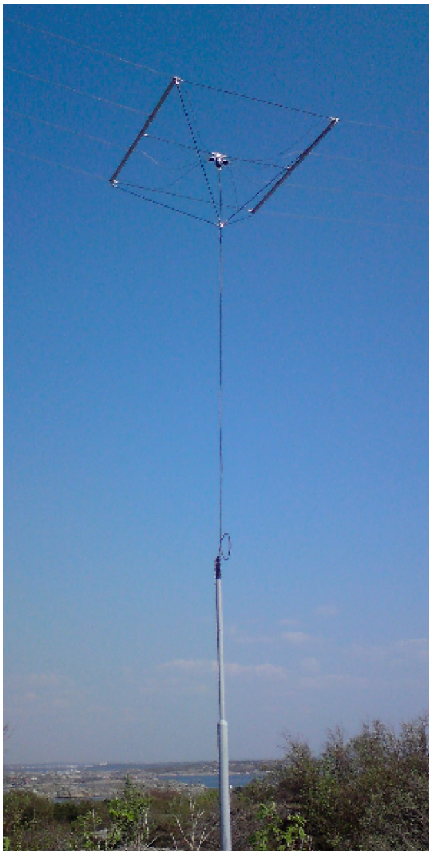
Fig. Mittsektion, matningspunkt 10 meter över mark, stolpe 3 m innehåller anslutning till jordnät och markförlagd koaxialkabel.
